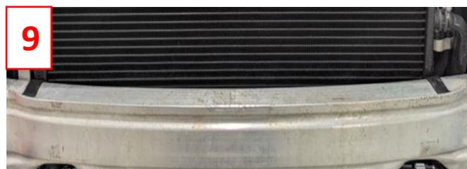
Jetzt wird der Siliokonschlauch 001004344 auf der Beifahrerseite an den WT Wasserkühler 004001027 adaptiert und unterhalb der Quertraverse verlegt. Zur Befestigung nutzen Sie die vormontierten Stangenhalter an der Quertraverse. Schließen Sie jetzt den Silikonschlauch an den oberen Anschluss des Originalen Niedertemperaturkühlers an. (10)
