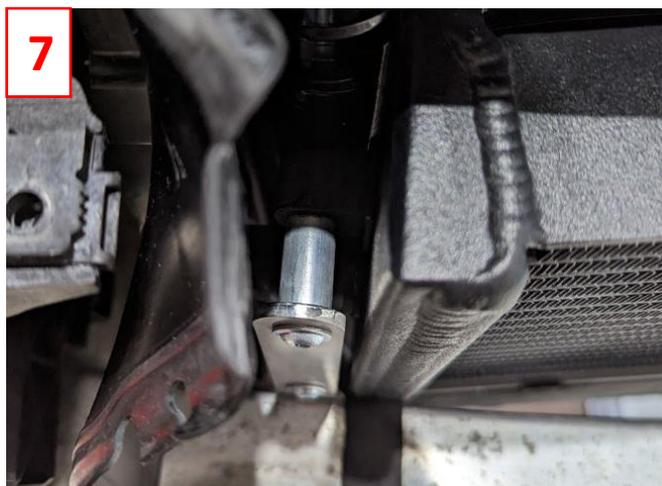
Montieren sie im nächsten Schritt den Halter 001002523 am Radiator 004001027 und am Schlossträger im Bereich der Haubenverriegelung. Nutzen Sie die Schrauben M6x12 und Unterlegscheiben 6mm.(8)
