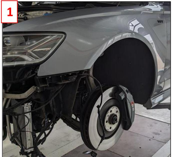
Demontieren Sie die Quertraverse. Je nach Fahrzeugmodell, müssen im Vorfeld die Scheinwerfer demontiert werden.(2)
