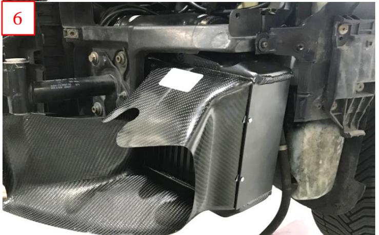
Verbinden Sie nun die Ladeluftkühlerschläuche auf beiden Seiten mit dem Ladeluftkühler. Achten Sie auf festen Sitz der Schellen. (7)
