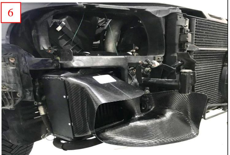
Entfernen der Stoßstange. Ladeluftkühler und Luftführungen fest verschrauben. (6)
