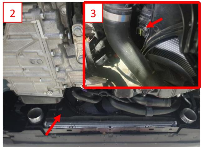
Demontieren Sie die Ladedruckleitung an den beiden Befestigungspunkten und nehmen Sie diese nach oben heraus(4).
